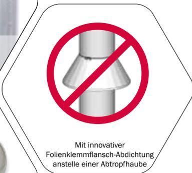
Mit innovativer Folienklemmflansch-Abdichtung anstelle einer Abtropfhaube
