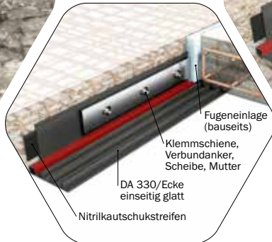
KRASOflex® Klemmkonstruktion - innenliegend
